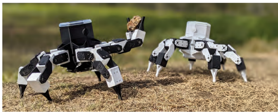
Dos robots hexápodos Gizmo-Syropod de CSIRO, diseñados para espacios confinados y que pueden inspeccionar y mapear cavidades en techos y suelos a las que los humanos tienen difícil o peligroso acceso. Foto: CSIRO.
