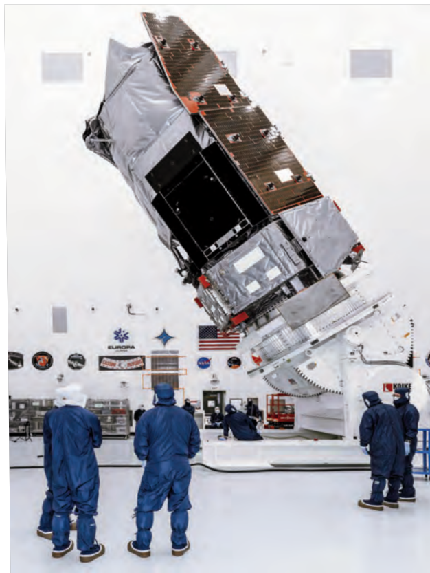
Técnicos e ingenieros dentro de la Instalación de Servicio de Carga Útil Peligrosa en el Centro Espacial Kennedy de la NASA en Florida giran el Telescopio Espacial Nancy Grace Roman de la agencia a la posición vertical el jueves 25 de junio de 2026, utilizando equipos de manipulación de precisión. Foto: NASA/Sydney Rohde (Rocz)
