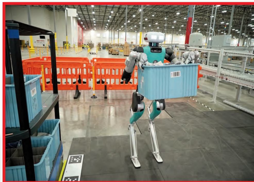
El robot multipropósito humanoides Digit, de Agility, puede realizar múltiples tareas en los almacenes sin requerir una nueva inversión en soporte físico para cada nueva tarea que efectúe. Foto: Robótica Agilidad.
