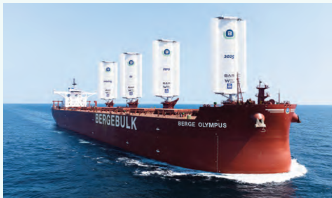
Buque granelero Berge Olympus, con cuatro WindWings. Foto: Manta Marine.
